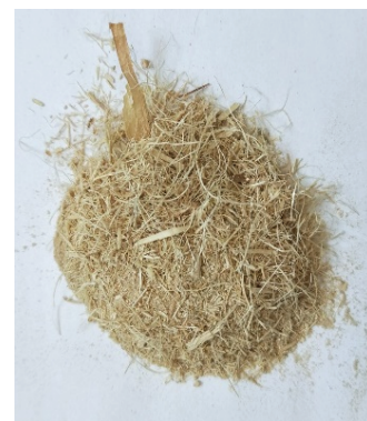
图 1 玉米秸秆破碎后0.5~1 mm部分 Fig 1 0.5~1 mm part in crush corn straw powder
