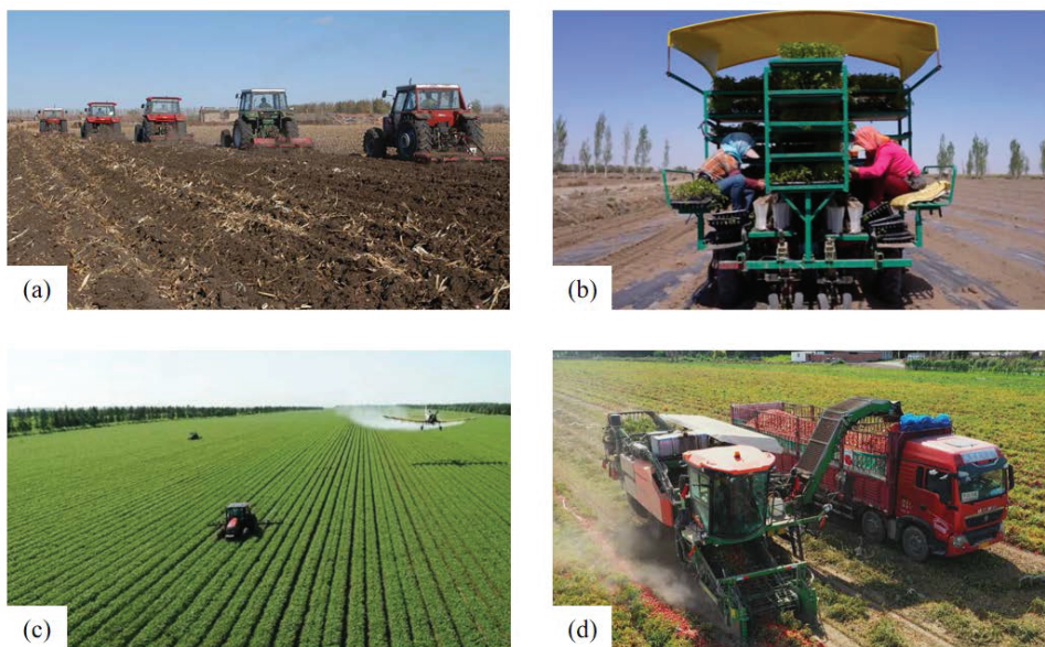
图2 加工番茄全程生产机械化作业环节 (a) 耕整地, (b) 移栽, (c) 植保, (d) 采收
