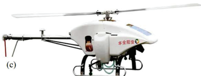
图 14 四种旋翼无人机 (a) 电动多旋翼MG-1S, (b) 油动多旋翼DZ310, (c) 电动单旋翼S40-A, (d) 油动单旋翼3WQF120-12
