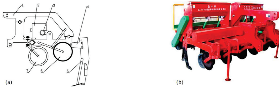
图3 1ZTS-200振动深松机 (a) 结构简图, (b) 样机
