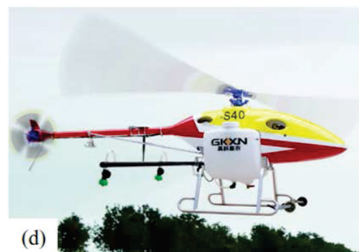
图 14 四种旋翼无人机 (a) 电动多旋翼MG-1S, (b) 油动多旋翼DZ310, (c) 电动单旋翼S40-A, (d) 油动单旋翼3WQF120-12
