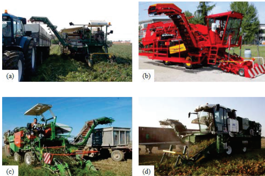
图 19 国外加工番茄采收机械 (a) 美国FMC公司SL350T型, (b) 意大利Pomac公司COMSO系列, (c) 意大利GUARESI G89/93 MS40型, (d) 意大利MTS公司THV自走式
