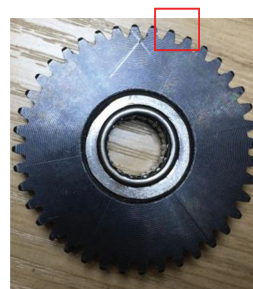
图 6 行星齿轮故障
