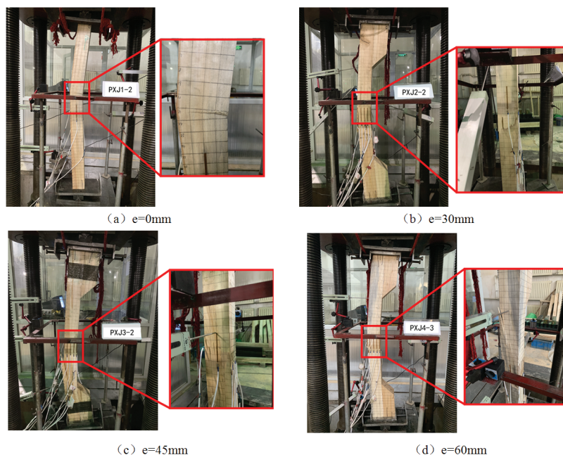
图 4 轴压和偏压木柱典型的破坏形态
